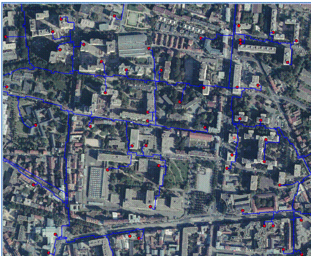
Figure 5 : Représentation sous Mapinfo du réseau de chaleur (en bleu) et des sous-stations (en rouge).
