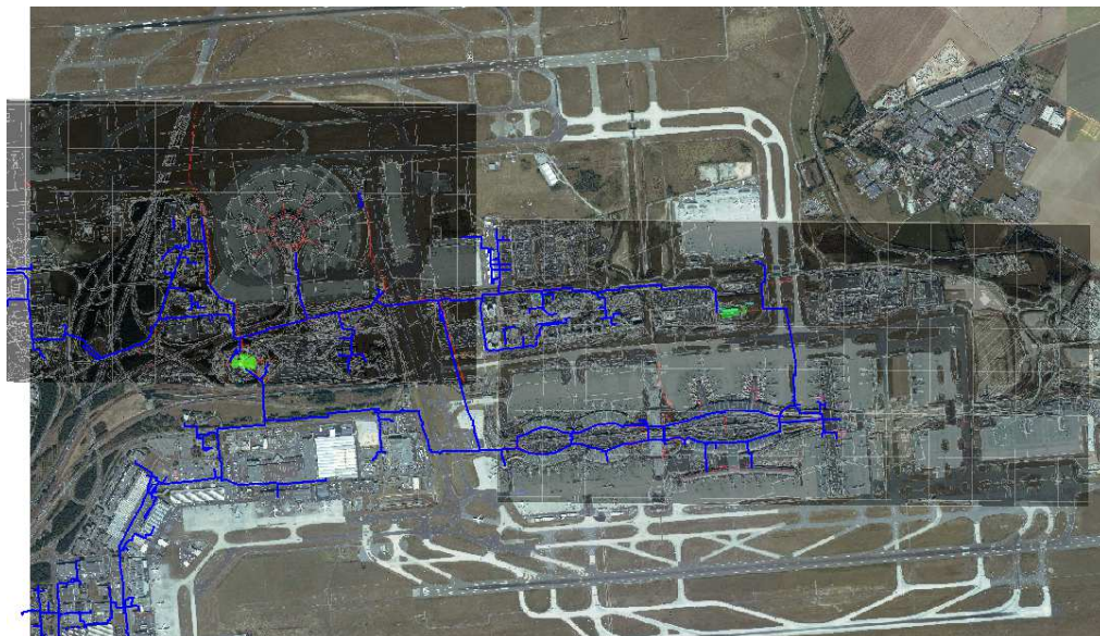
Figure 2: Plan de géomètre avec vectorisation du réseau de chaleur en bleu.
