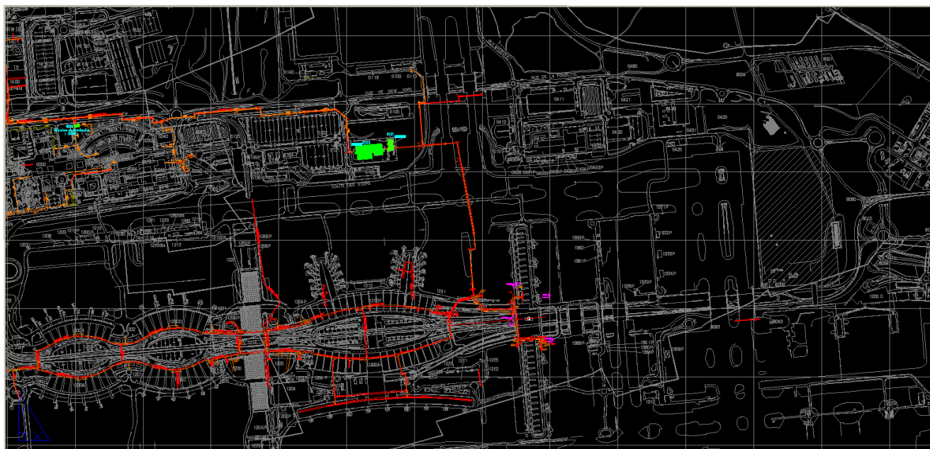
Figure 1 : Plan géométrique permettant une vectorisation du réseau de chaleur.
