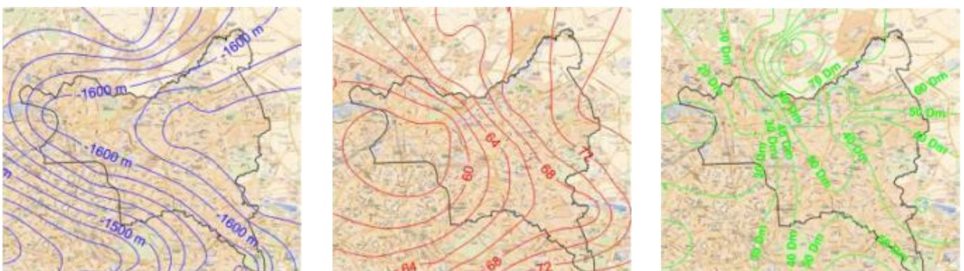
Figure 16 : Profondeur (gauche), Température (centre) et Transmissivité (droite) des Calcaires du Dogger
